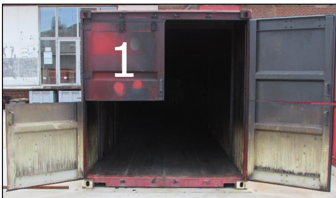
figuur 5 De positie van de deuren bij aanvang van het deel flamekoeling.
