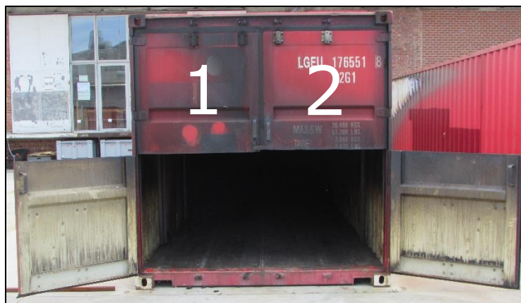
figuur 6 Tijdens het deel flamecooling zal met deur 2 gespeeld worden om een kleine rooklaag te behouden. Aan het einde van deel 2, zal deur 2 gesloten worden
