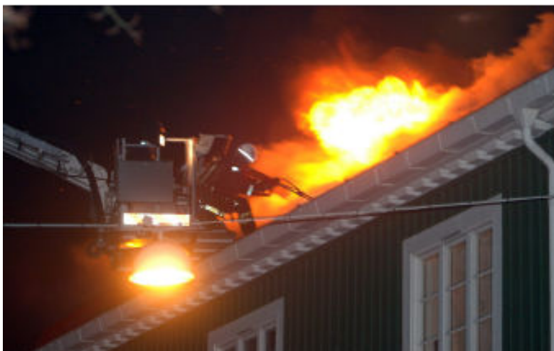
Fig 6.1 Cobra unit ingebouwd op het platform van een hoogtewerker. Het pistool is bevestigd aan de korf terwijl de pomp beneden op het chassis gemonteerd is.
