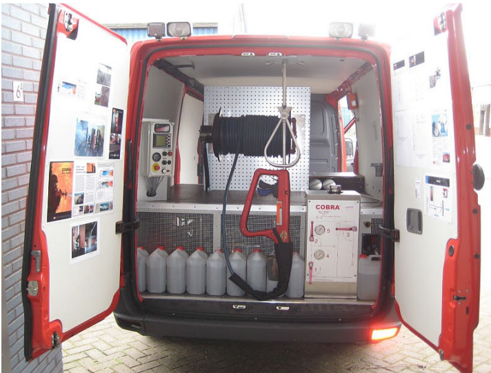
Fig 1.1 Het COBRA systeem gemonteerd in een Mercedes sprinter. Rechts onder zien we het bedieningspaneel. Daarnaast is het rode pistool te zien. Achteraan zien we de haspel. Verder zien we onderaan een aantal vaatjes abrasief. (Foto: Willem Nater)
