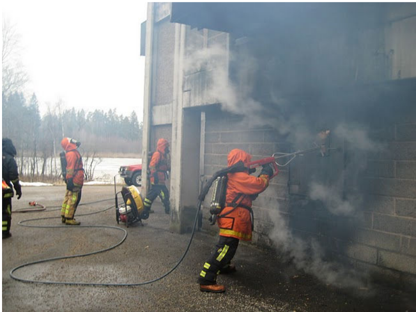
Fig 4.2 De COBRA wordt (bijna) altijd gecombineerd met de inzet van één of meerdere overdrukventilatoren. Een degelijke kennis van ventilatietechnieken is dus onontbeerlijk voor de COBRA gebruiker en zeker voor de COBRA instructeur. (Foto: Willem Nater)
