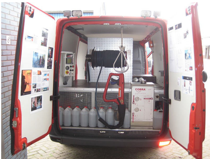
Fig 1.1 Het COBRA systeem gemonteerd in een Mercedes sprinter. Rechts onder zien we het bedieningspaneel. Daarnaast is het rode pistool te zien. Achteraan zien we de haspel. Verder zien we onderaan een aantal vaatjes abrasief. (Foto: Willem Nater)
