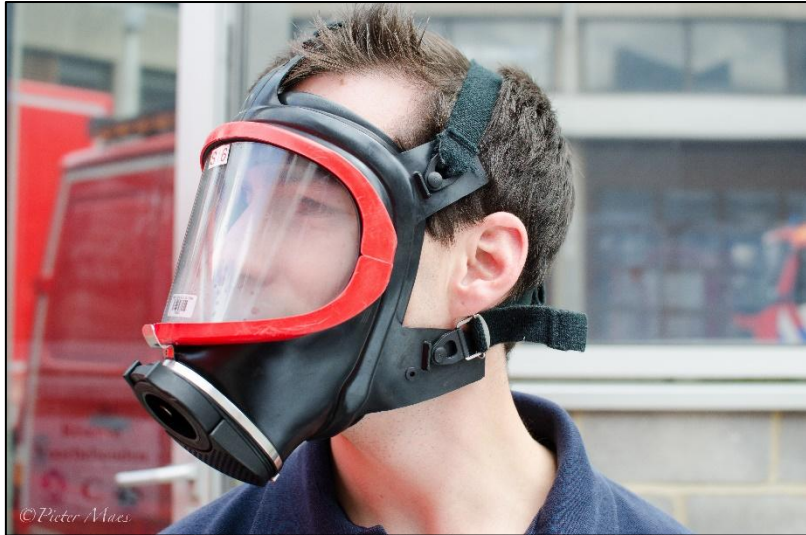
图 4 可戴于受害者头部的救援面罩，必须连接调节器或肺活量阀，并最好使用加长的软管，以便受害者和消防员能够同时轻松移动。 (图:Bart Noyens)
