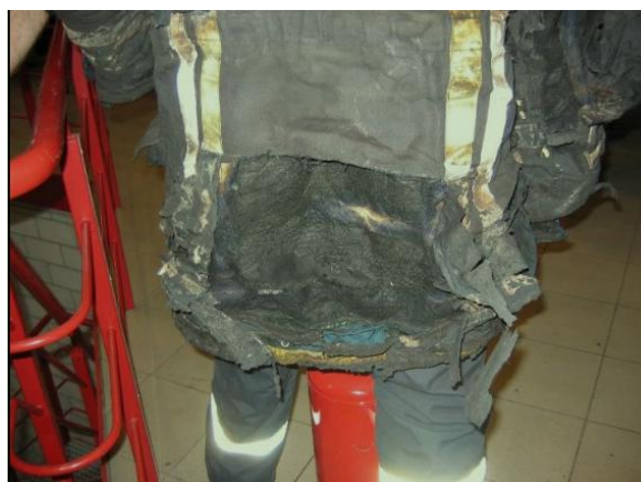
图 3 这是其中一名消防员严重损坏的防护服。（来源：韦斯托克消防局 - 迪克斯穆德消防站）
