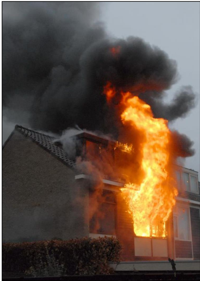
Figura 3 Vista de um incêndio totalmente desenvolvido a sair de duas janelas. (Foto: www.nufoto.nl )
