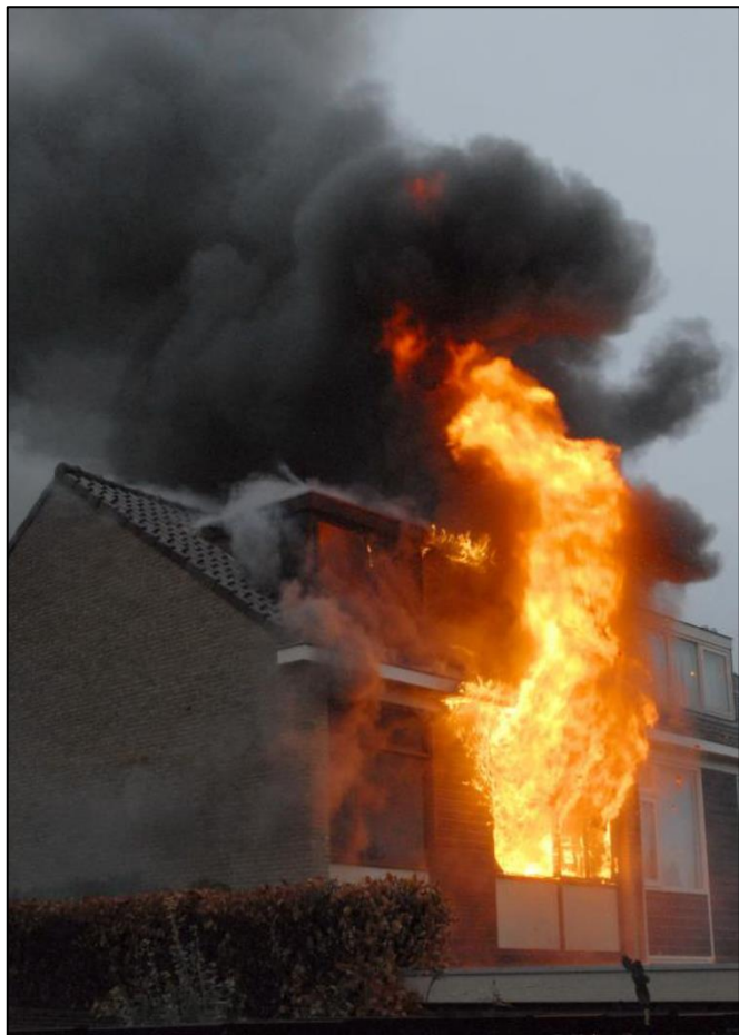
Figura 3 Vista de un incendio totalmente desarrollado ventilado por dos ventanas. (Photo: www.nufoto.nl )
