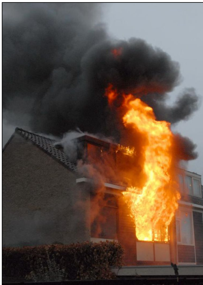
Bild 3 Ansicht eines vollentwickelten Brandes, bei dem die Flammen aus einem Doppelfenster schlagen. (Foto: www.nufoto.nl )
