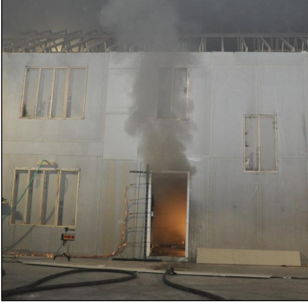
Şekil 4 Kapının üst tarafından duman çıkarken diğer kısımlardan içeriye hava giriyor. (Fotoğraf: Steve Kerber – Underwriters Laboratories)
