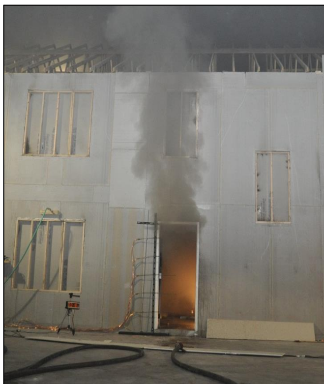
figura 4 O fumo a sair pela extremidade superior da porta enquanto a restante da abertura da porta é utilizada para a entrada de ar. O ar fresco fará com que o incêndio se desenvolva mais rapidamente. (Foto: Steve Kerber – Underwriters Laboratories)
