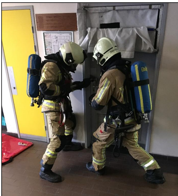
figuur 5 Combinatie van werken met de haligan tool en de rookstopper tijdens een deurprocedure. (Foto: Pieter Maes)
