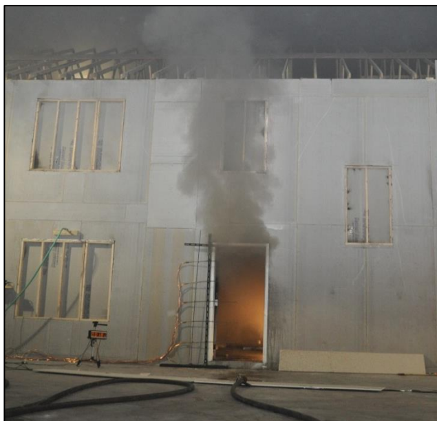
Figura 3 Il fumo esce dalla parte superiore della porta mentre il resto dell'apertura è occupato dall'aria in entrata. L'aria in entrata farà crescere l'incendio più velocemente. (Photo: Steve Kerber – Underwriters Laboratories)
