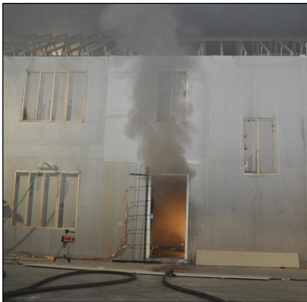
Image 4 La fumée sort par l'extrémité supérieure de la porte, tandis que le reste de l'ouverture est utilisé pour l'air entrant. L'air frais accélérera la croissance du feu. (Photo: Steve Kerber - Underwriters Laboratories)
