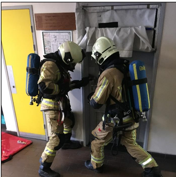
Image 5 Combinaison du travail avec l'outil halligan et de l'utilisation du stoppeur de fumée lors d'une procédure d'ouverture de porte. (Photo: Pieter Maes)
