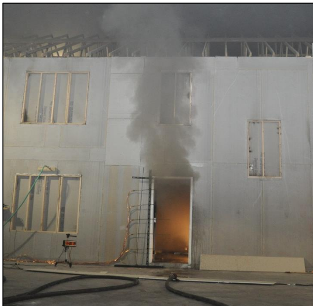
Figura 4 El humo sale por el extremo superior de la puerta mientras que el resto de la abertura de la puerta se usa para que el aire fluya hacia adentro. El aire fresco hará que el fuego crezca más rápido. (Photo: Steve Kerber – Underwriters Laboratories)
