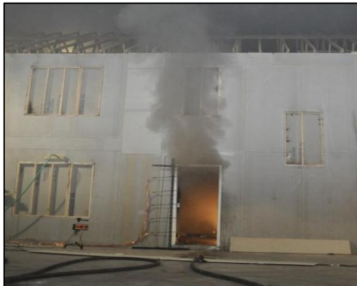
图 4 烟从门的顶端逸出，而门的其余部分用于空气的流入，新鲜的空气会使火势发展得更快。（拍摄：Steve Kerber - Underwriters Laboratories）
