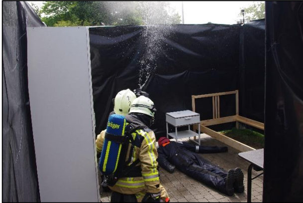
figuur 4 Het doorzoeken met een slang duurt langer en het luchtdebiet neemt toe. (Foto: Steve De Blauwe)
