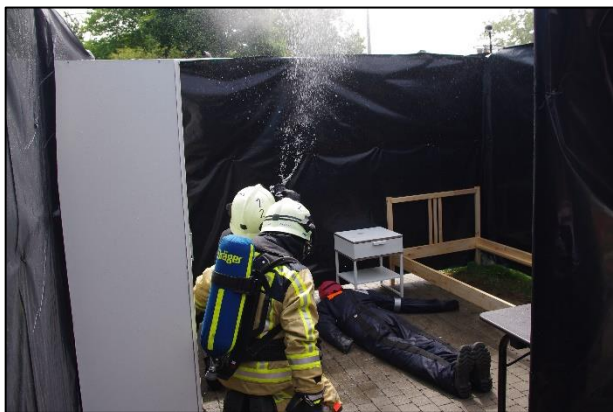
Figura 4 Effettuare la ricerca con la mandata in pressione richiede più tempo con un consumo d'aria maggiore. (Photo: Steve De Blauwe)
