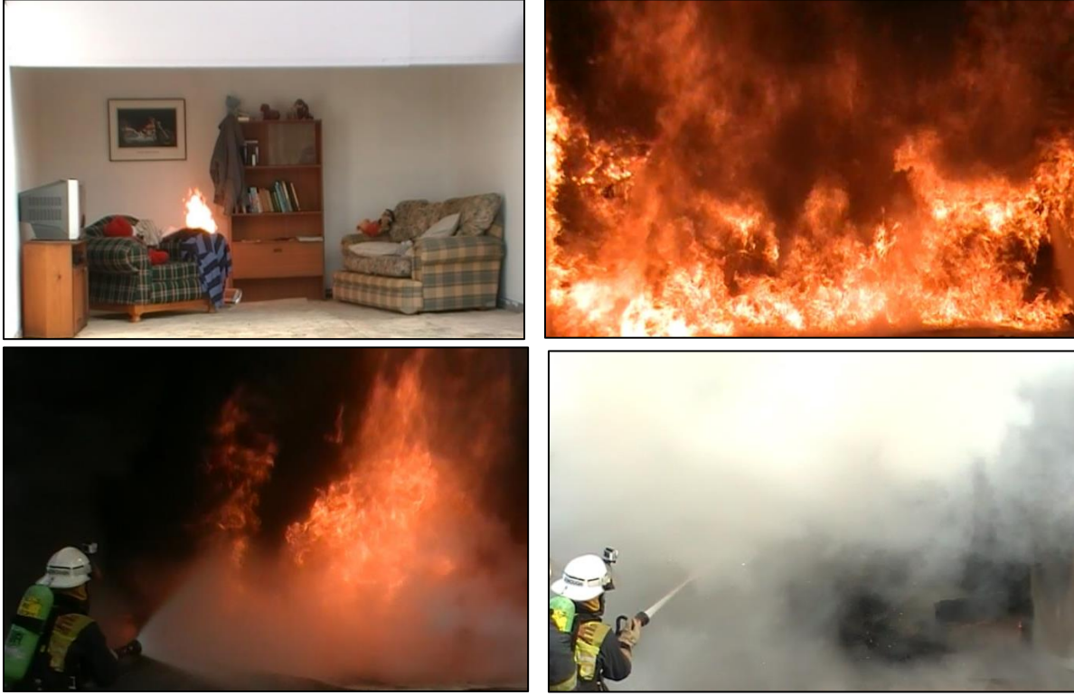
Şekil 6 Bir başlangıç yangınının (yukarıda solda) tam gelişmiş yangına (yukarıda sağda) dönüşümü. Sonrasında tam gelişmiş yangın dolaylı söndürme tekniği kullanılarak karartılıyor. Dolaylı söndürme tekniği altta soldaki resimde görülebilir. Yangın karardıktan sonra, itfaiyeci doğrudan söndürme tekniğine geçip yangını tamamen söndürüyor. (Fotoğraf: New South Wales İtfaiyesi)
