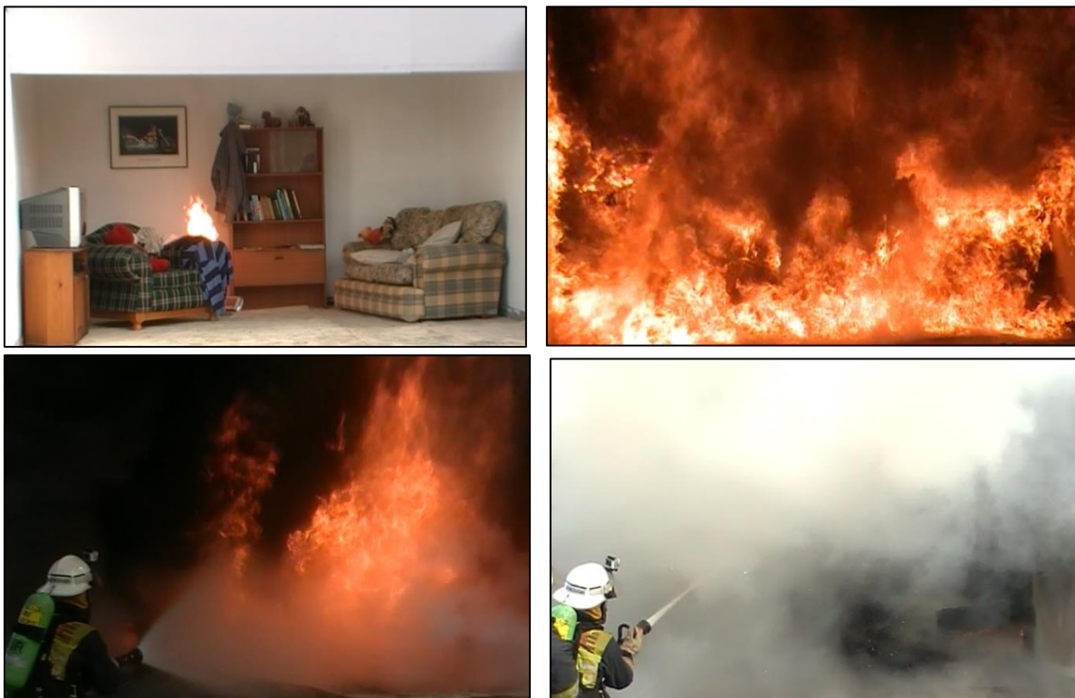
figuur 6 De evolutie van een beginnende brand (linksboven) die volontwikkeld wordt (rechtsboven). Vervolgens wordt de volontwikkelde brand aangepakt met een indirecte aanval. De indirecte aanval is volop bezig op de foto linksonder. Na knockdown moet overgeschakeld worden op een directe aanval om de brand definitief te blussen. (Foto: New South Wales Fire & Rescue Service)
