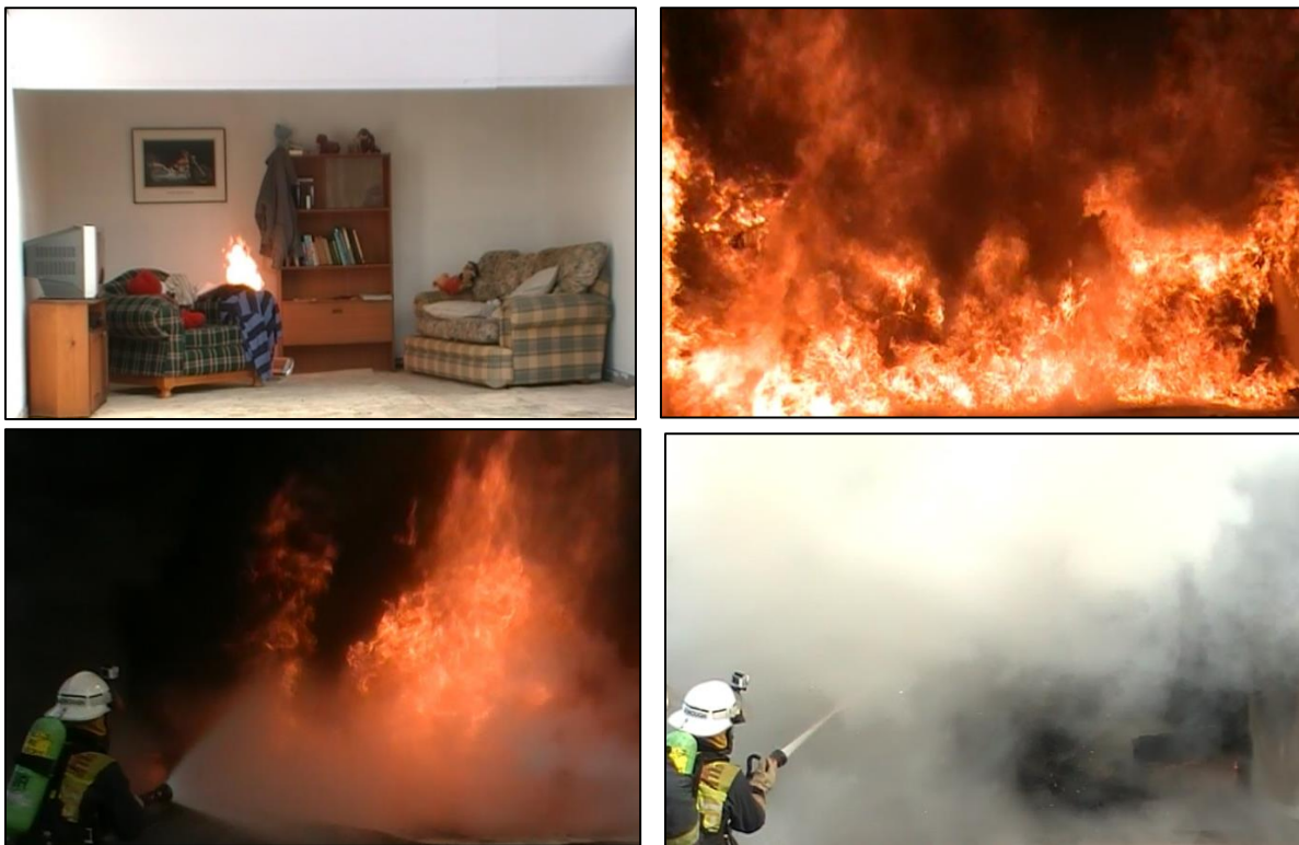
Figura 6 Lo sviluppo di un principio d'incendio (in alto a sinistra) a completamente sviluppato (in alto a destra). Successivamente l'incendio viene abbattuto usando un attacco indiretto. Questo attacco indiretto è riportato nell'immagine in basso a sinistra. Dopo si deve passare ad un attacco diretto per estinguere completamente l'incendio. (Photo: New South Wales Fire & Rescue Service)
