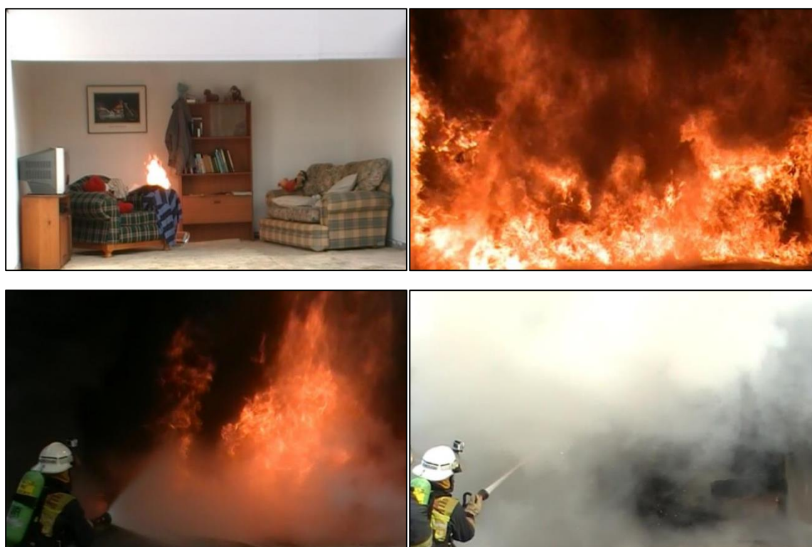
图6 火势从开始发展(左上)到全面燃烧(右上)。接下来，使用间接进攻扑救全面燃烧的火场。这种间接进攻可以在左下角的图像中看到。在被扑灭后，消防员必须切换到直接进攻，以完全扑灭大火。(图:新南威尔士州消防队)
