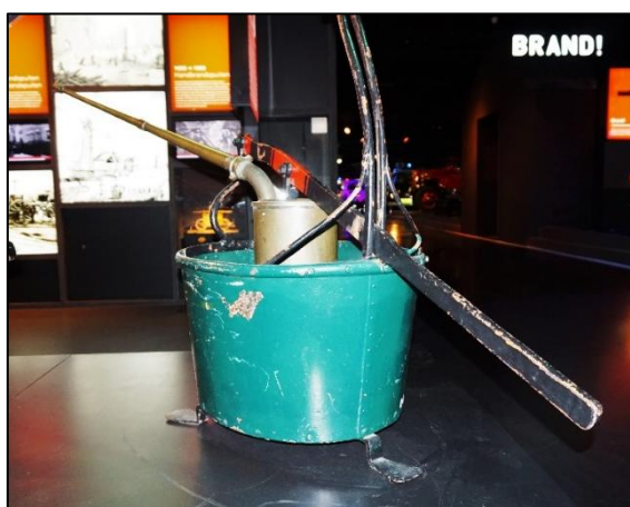
图1 第一批“消防泵”，喷嘴安装固定，不能改变方向。（图：荷兰 Hellevoetsluis 消防博物馆）
