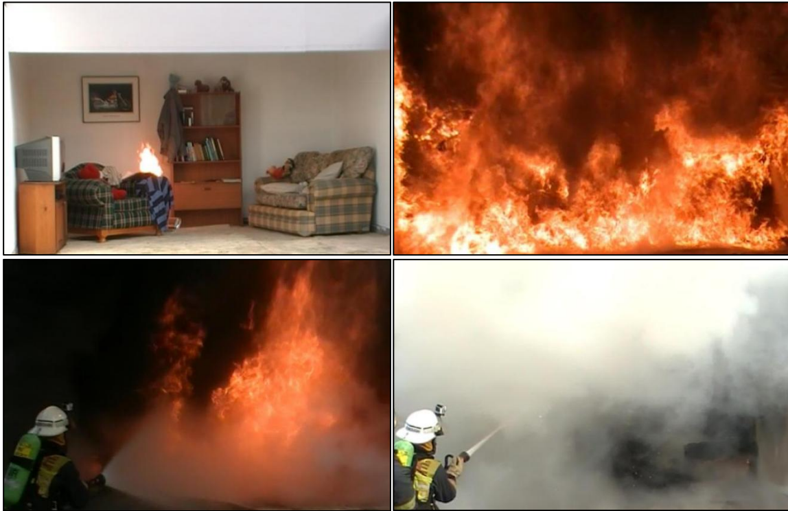
图6 火势从开始发展(左上)到全面燃烧(右上)。接下来,使用间接进攻控制全面燃烧阶段的火场(图左下)。控制住火势后,消防员必须切换到直接进攻以完全扑灭大火。(图:新南威尔士州消防队)
