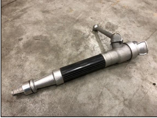
Şekil 4 Bu günlerde bu eski lansın modern tipleri vardır. Bunlara ABD'de düz boru denir.
