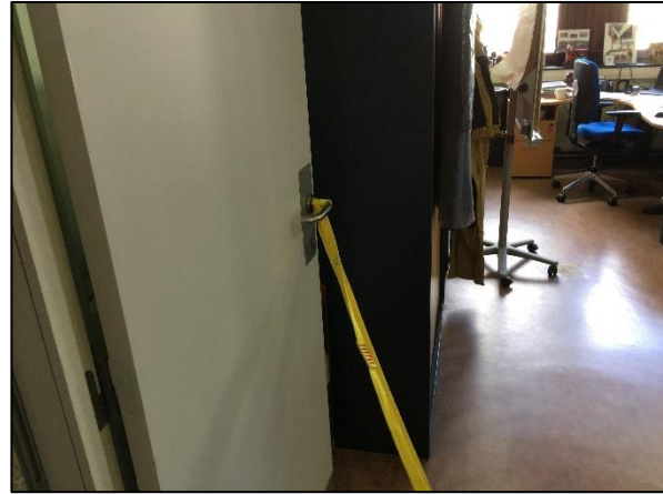
Figura 15 e 16 Un'asola è fissata alla maniglia o al pomello della porta. La porta può quindi essere chiusa velocemente semplicemente tirandola, mantenendo il controllo della porta.
