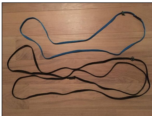
Figura 1 Due fettucce per l'arrampicata sportiva. Entrambe hanno un carico di lavoro di 2,2 kN. Quella in alto è di 1,20 m e quella in basso è di 2,30 m.
