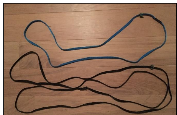
Figura1. Dos eslingas de escalada. Ambas soportan 2.2Kn. La de arriba es de 1m20 y la de abajo es de 2m30. (Photo: Filip Lemmens)
