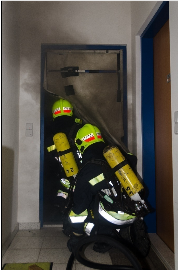
Figura 4 El equipo ha colocado el bloqueador de humos en el lugar del incendio. Esto restringe la salida de humo al pasillo. Tan pronto como el equipo de ataque pasa la puerta, la cortina cae abajo casi completamente bloqueando el flujo. Esto crea una protección extra para los habitantes del resto del edificio. (Photo: Lukas Derkits / Fire Department Wiener Neudorf, Austria)
