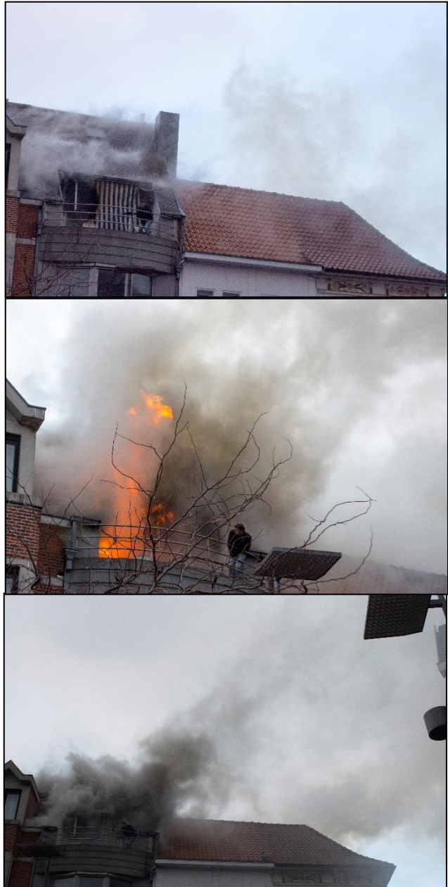
图 1, 2 和 3 火灾发生时这栋公寓的住户别无他法，只能逃到阳台处。但是，火势的发展太过迅速。图 1 显示只有一点冒烟，该男子还很安全。三分钟后，烟气增多，五分钟后火势发展为全面燃烧。如果该男子不能被迅速救出，那他会因为受不了火焰的热辐射而跳楼。（来自：Tom Vanryckegem）
