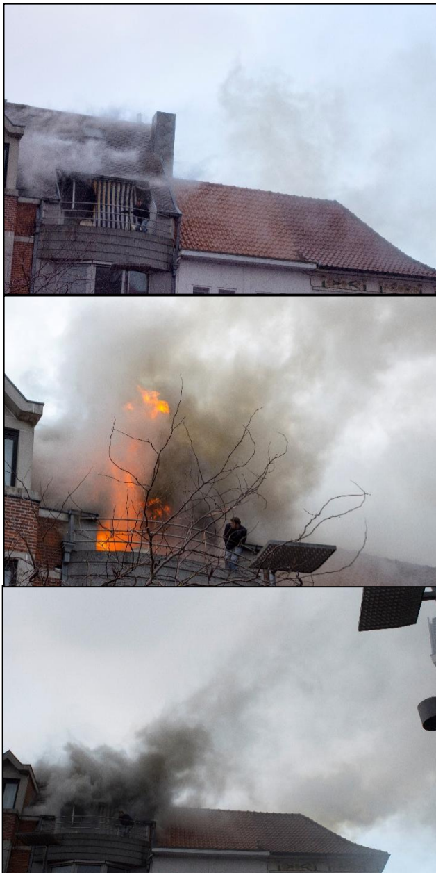
图 1, 2 和 3 火灾发生时，这栋公寓的住户别无选择，只能逃到阳台处。但是，火势发展太过迅速。图 1 显示只有一点烟，该男子还很安全。三分钟后，烟气增多，又过两分钟，火势发展为猛烈燃烧。如果该男子不能被尽快救出，他会因为受不了火焰的热辐射而跳楼。（来自：Tom Vanryckegem）
