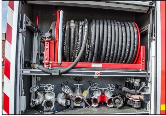
Şekil 1 Araç üzerindeki yüksek basınç çıkırığı. Hemen altında, fikrasyonlar ve düşük basınç lansları (Fotoğraf: Pierre-Henri Demeyere)
