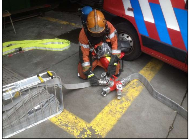
Şekil 6 Toplanmış hortum demetleri ve hortum sepetlerinin birlikte kullanıldığı farklı sistem bileşenleri. 70 mm'lik hortum fikrasyona bağlanmıştır. Resimde hortum sepeti içindeki hortumun da fikrasyona bağlı olduğu görülüyor. Söndürme yapılacak yere kadar sepetteki hortum açılacak, su sıkılmaya başlanacak noktada ise yerdeki fosforlu sarı hortum demeti takılacak. (Fotoğraf: Karel Lambert )
