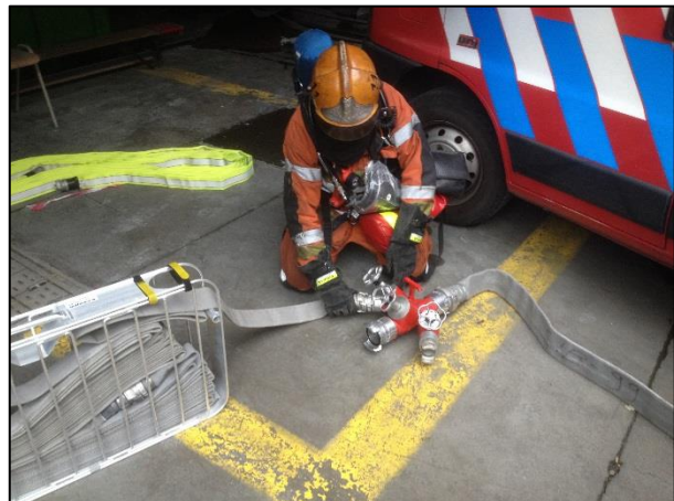
Figure 6 Os diversos componentes do sistema que utilizam cargas e cassetes de mangueira em espiral. A mangueira de 70 mm está conectada a um trijuntor. A imagem mostra a linha de mangueira em Z na cassete (malotes) conectada ao trijuntor. No ponto de ataque, uma linha de mangueira amarela será conectada à linha da cassete. (Foto: Karel Lambert )
