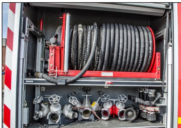
Figura 1 Carretel de alta pressão em viatura. Abaixo deste estão os divisores/conjuntos e as agulhetas de baixa pressão. (Foto: Pierre-Henri Demeyere)
