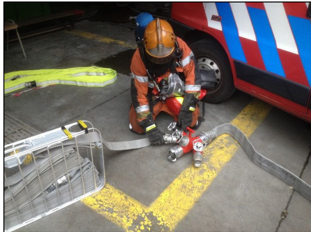
Bild 6 Die verschiedenen Komponenten der Schlauchbündel- und Kassettsysteme. Die 70 mm Leitung ist an einen Drei-Wege-Verteiler gekuppelt. Das Bild zeigt, wie der, in der Kassette geschichtete Schlauch, an den Verteiler angeschlossen wird. Am Angriffspunkt wird später ein gelbes Schlauchbündel an den Schlauch aus der Kassette gekuppelt. (Foto: Karel Lambert )
