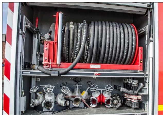
Bild 1 Hochdruckhaspel in einem Fahrzeug. Unter der Haspel erkennt man einige Verteiler und Niederdruckstrahlrohre. (Foto: Pierre-Henri Demeyere)
