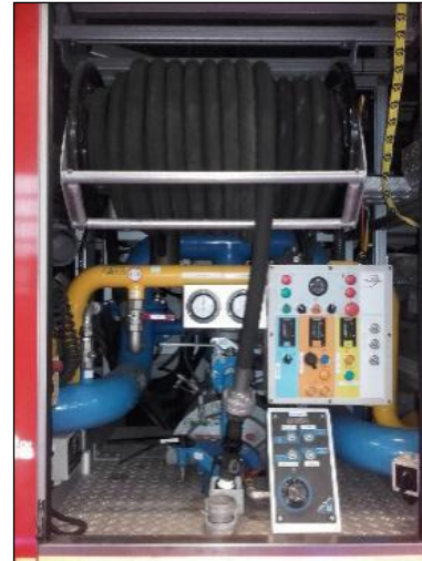
图 8 在水罐车尾部装配的低压软管卷盘（照片：Jean-Claude Vantorre）
