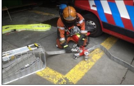
图6 在供水系统中的不同部位采用单卷水带和折叠水带。70 毫米水带连接三分水器。图中显示了将折叠水带连接到分水器。在射水时，黄色单卷水带将连接到折叠水带中。（照片：卡雷尔兰伯特）
