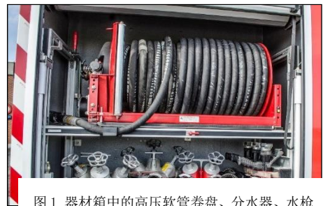
图1 器材箱中的高压软管卷盘、分水器、水枪
