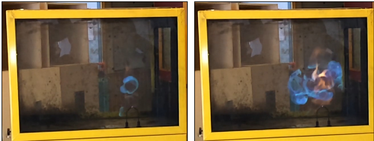
Şekil 1: Gaz ve hava karışımının tutuşması. Soldaki resimde tutuşma henüz oluşmuştur. Alev yüzeyi dairesel bir şekilde her yöne ilerlemektedir. Sağdaki resimde alev hacminin arttığını göstermektedir. (Fotoğraflar: Karel Lambert)
