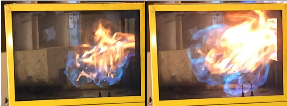
Figura 2 Estas fotos mostram o restante processo de reação ilustrado na figura 1. A imagem da esquerda mostra a chama a propagar-se mais longe. Isto também é mostrado na imagem da direita. Nesta as chamas propagam-se ao longo de todo o volume, no qual a mistura está dentro do campo de inflamabilidade. (Fotos: Karel Lambert)
