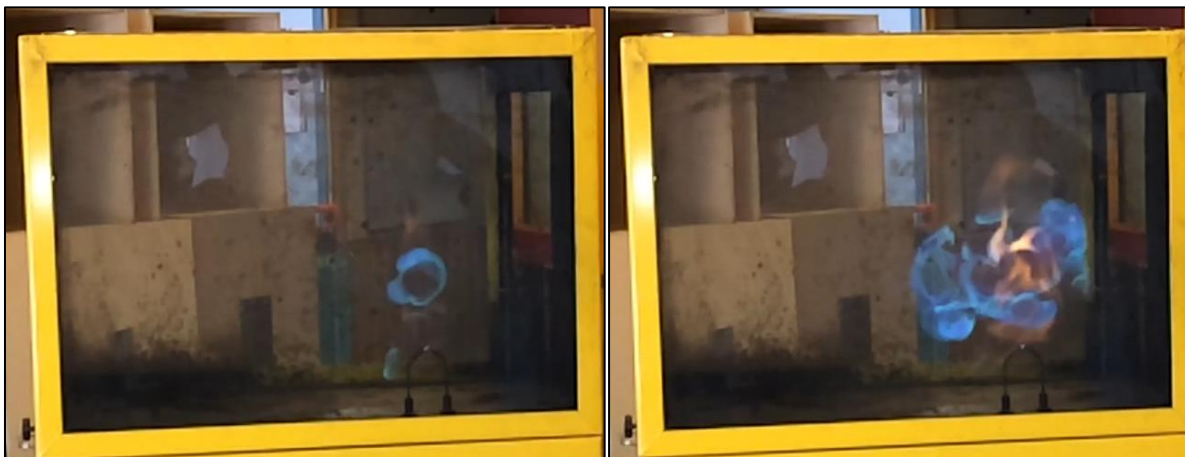
Figura 1 Ignição numa mistura de gás e ar. Na imagem da esquerda, a ignição acaba de ocorrer. A frente de chama move-se de forma circular em todas as direções. Na imagem da direita mostra-se um incremento no volume de chamas. (Fotos: Karel Lambert)
