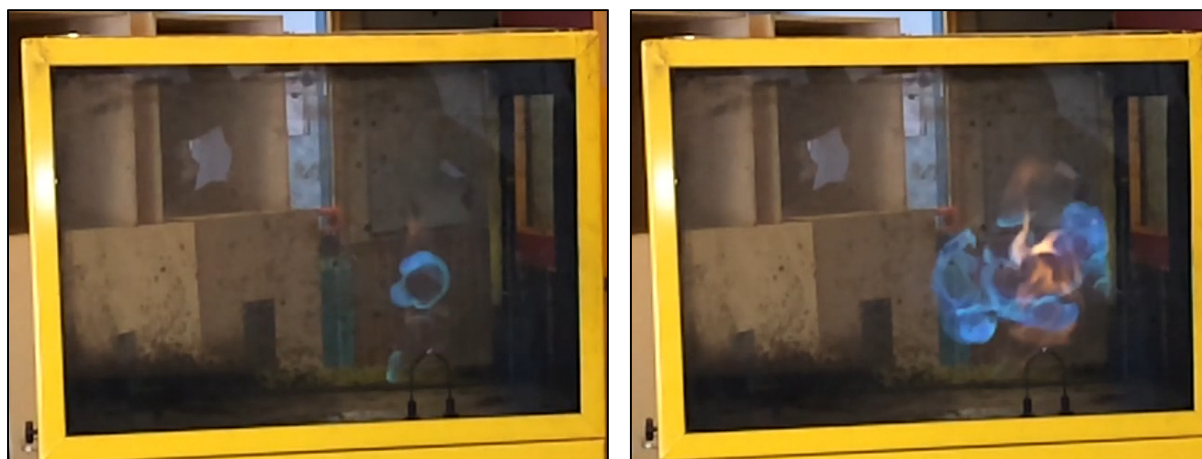
Figuur 1 Ontsteking van een mengsel van gas en lucht. Op de linker foto heeft de ontsteking net plaatsgevonden. Het vlamfront beweegt zich bolvormig in alle richtingen. Op de rechterfoto is het volume vlammen een stuk groter geworden. (Foto's: Karel Lambert)
