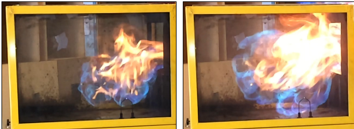
Figuur 2 Deze foto's tonen het verdere verloop van de reactie in Figuur 1. Op de linker foto is het vlamfront verder aan het uitbreiden. Dit is ook geval op de rechter foto. Op deze manier verspreidt de vlam zich doorheen het volledige volume waarvan het mengsel in het brandbare gebied zit. (Foto's: Karel Lambert)
