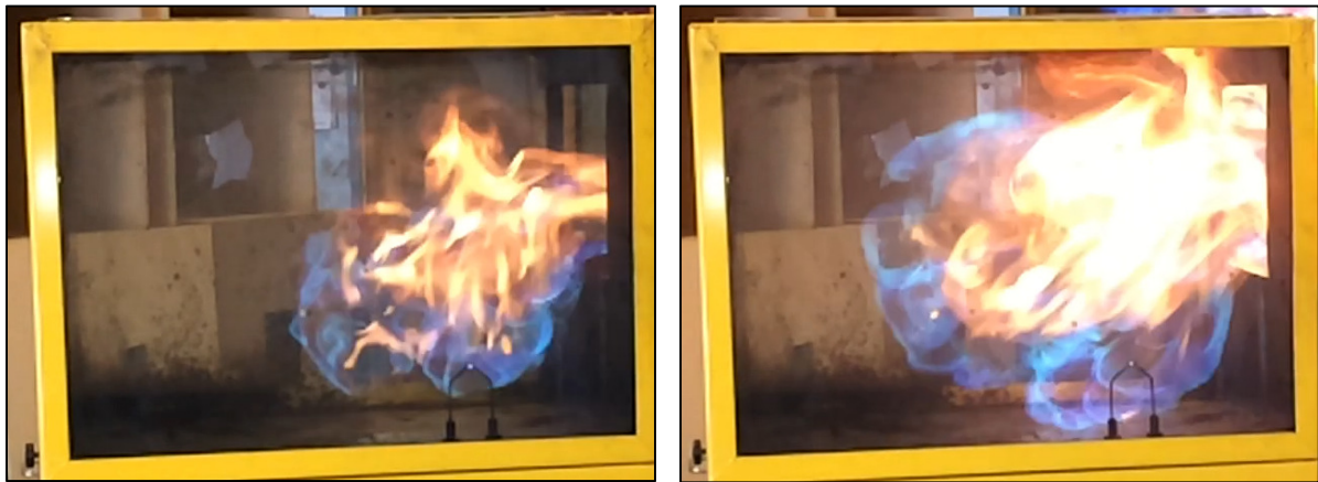
Figura 2 Queste foto mostrano il resto del processo di reazione illustrato nella figura 1. La foto a sinistra mostra la fiamma diffondersi quanto più possibile. Questo fenomeno si vede anche nella foto di destra. In questo modo, le fiamme si stanno diffondendo lungo l'intero volume della miscela che si trova all'interno del campo di infiammabilità. (Photo's: Karel Lambert)
