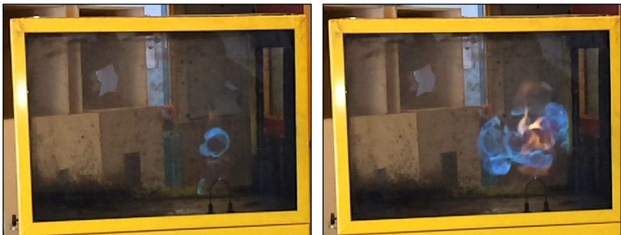
Image 1 Allumage d'un mélange d'air et de gaz. Sur l'image de gauche, l'allumage vient juste de se produire. Le front de flamme se déplace de manière circulaire dans toutes les directions. L'image de droite montre une augmentation du volume des flammes ( Photo: Karel Lambert )
