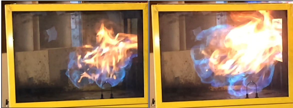
Figura 2 Estas fotos muestran el resto del proceso de reacción ilustrado en la figura 1. La imagen de la izquierda muestra la llama propagándose más lejos. Esto también se muestra en la imagen de la derecha. De esta forma, las llamas se propagan a lo largo de todo el volumen en el cual la mezcla está dentro del rango de inflamabilidad. (Photo's: Karel Lambert)
