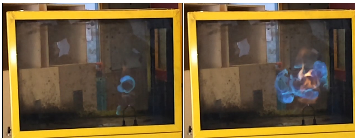
Figura 1 Ignición de una mezcla de gas y aire. En la imagen de la izquierda, la ignición acaba de ocurrir. El frente de llama se mueve de una forma circular en todas las direcciones. En la imagen de la derecha se muestra un incremento en el volumen de las llamas. (Photo's: Karel Lambert)
