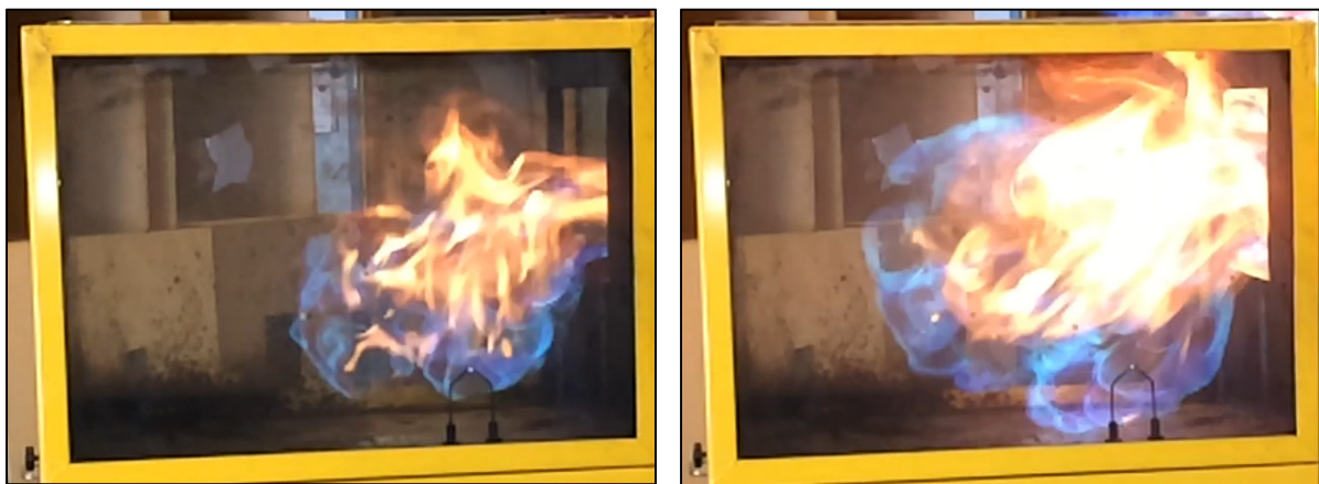
Bild 2 Diese Aufnahmen zeigen den weiteren Verlauf der Reaktion von Bild 1. Auf dem linken Bild sieht man, dass die Flammenfront sich weiter ausbreitet. Das ist auch auf dem rechten Foto der Fall. Auf diese Weise breitet sich die Flamme durch das gesamte Volumen aus, dessen Gemisch sich im zündfähigen Bereich befindet. (Fotos: Karel Lambert)
