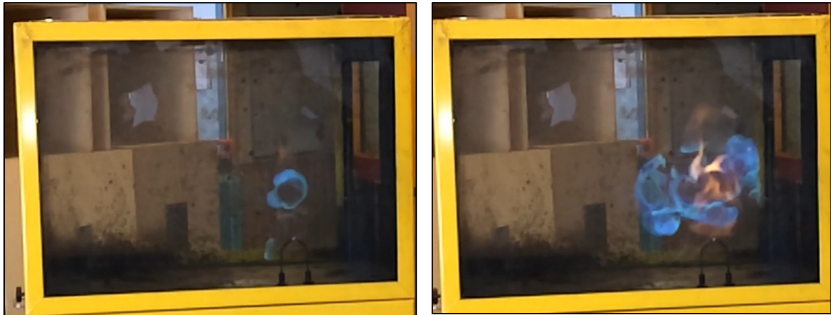
Bild 1 Entzündung eines Gas/Luftgemischs. Das linke Bild wurde unmittelbar nach der Entzündung aufgenommen. Die Flammenfront bewegt sich kugelförmig in alle Richtungen. Auf dem rechten Bild ist das Flammenvolumen bereits angewachsen. (Fotos: Karel Lambert)
