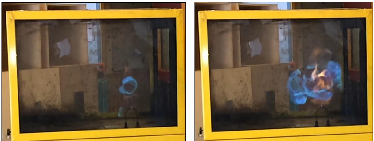
图1 点燃烟气与空气混合物。从左图中可以看到，刚点燃时火焰锋面以环形向四周扩散。右图可见火焰体积的扩大(图片：Karel Lambert)
