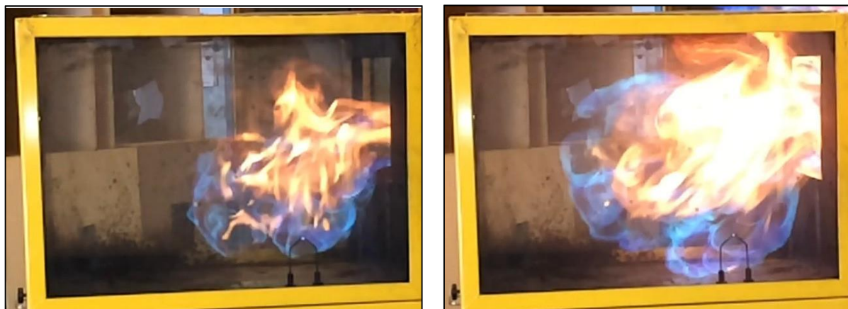
图 2 这些图片显示了图 1 之后的反应过程。两图均展示了火焰进一步扩散。这也是火焰在整个处在燃烧极限区间内的混合物内部蔓延的过程。（图片：Karel Lambert）
