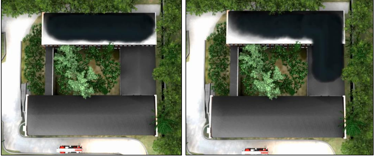
Şekil 7 A binasındaki yangın burada duman birikmesine neden olur(Sol üstteki resim). Duman konsantrasyonu dumanın sıcaklığıyla beraber artar. Duman C binasındaki boşluğa dolar. Burada duman birikmeye başlar (Sağ üstteki resim) Bir süre sonra B binasının çatısının altındaki boşluğa da duman dolmaya başlar. (altta sağdaki resim)Artık tüm boşluklar duman ve hava karışımı ile doludur.. (Şekil: [3])
