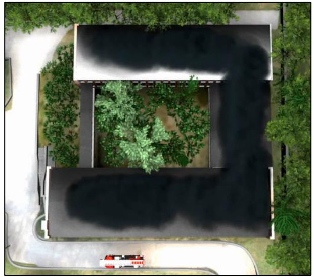
Şekil 7 A binasındaki yangın burada duman birikmesine neden olur(Sol üstteki resim). Duman konsantrasyonu dumanın sıcaklığıyla beraber artar. Duman C binasındaki boşluğa dolar. Burada duman birikmeye başlar (Sağ üstteki resim) Bir süre sonra B binasının çatısının altındaki boşluğa da duman dolmaya başlar. (altta sağdaki resim)Artık tüm boşluklar duman ve hava karışımı ile doludur.. (Şekil: [3])
