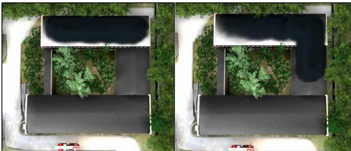
图 7 建筑 A 的火灾使烟气聚集（左上图）。烟气浓度随温度的上升而一起增加，烟气被挤入建筑 C 的中空空间，并在此处聚集（右上图）。一段时间后，建筑 B 的房顶下方空间也充满了浓烟。所有的中空空间内充满了热烟气与空气的混合物
