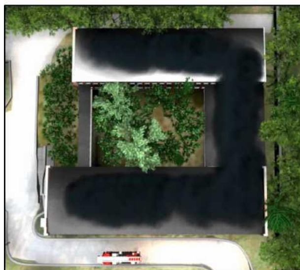
图 7 建筑 A 的火灾使烟气聚集（左上图）。烟气浓度随温度的上升而一起增加，烟气被挤入建筑 C 的中空空间，并在此处聚集（右上图）。一段时间后，建筑 B 的房顶下方空间也充满了浓烟。所有的中空空间内充满了热烟气与空气的混合物
