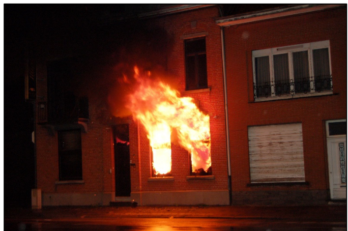
Figura 2 Este fuego puede ser atacado usando un ataque indirecto. Supongamos que el fuego es localizado justo en la planta primera o más alta, un ataque exterior corto con un chorro compacto contra el techo puede ofrecer la solución. (Photo: Nico Speleers)
