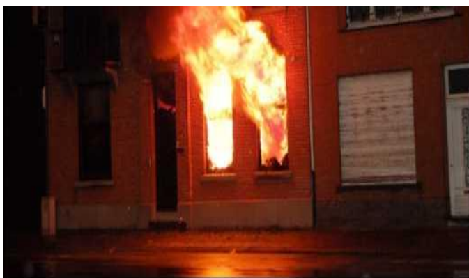
图3 在底层（这里说的底层，其实就是我们常说的第一层）处于全燃阶段的火灾可以用间接进攻扑灭。假如火灾发生在第二层或者更高的地方，那么采用全射流朝天花板射水以进行短暂的外部进攻可以解决这一问题。
