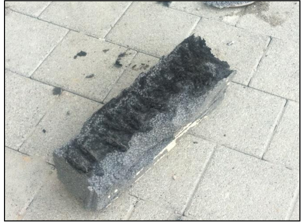
Şekil 7 Kısmen yanmış EPS yalıtımının fotoğrafı. Üst kısım için için yanmış ve kararmış. Parçanın geri kalanı orijinal gri rengini korumuştur. (Fotoğraf: Pieter Maes)
