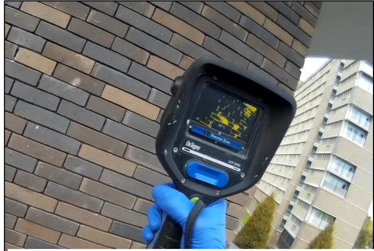
Şekil 3 Duvar iyi görünüyor. Ancak termal kamera ısı birikiminin izlerini açıkça gösteriyor. Derzler ve bazı tuğlalar belirginleşiyor. (Photo: Karel Lambert)
