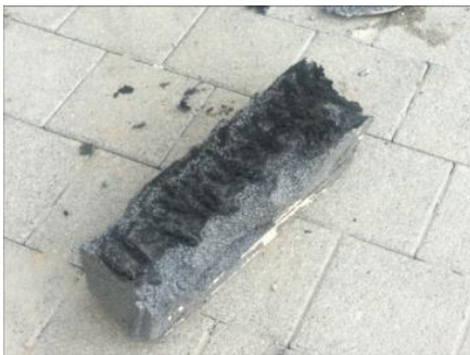
图 8 EPS 隔热保温材料部分烧焦的照片。上半部分一直在阴燃，并且已经变黑了。剩余部分保持了原来的灰色。照片由 Pieter Maes 提供。
