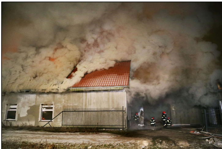
Figuur 7 In deze onder geventileerde brand loopt de temperatuur binnen hoog op. De overdruk binnen perst de rookgassen naar buiten. (© Foto: Zbigniew Wozniak)
