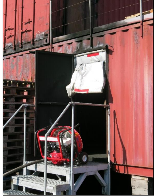
Şekil 6 Duman durdurucu kapı açıklığının üst yarısını kapatır. Fanın neden olduğu geri akış sınırlıdır. Fan kapıya daha yakın yerleştirilebilir. (Fotoğraf: Michael Reick)
