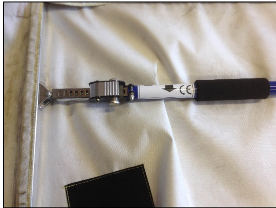
Figuur 4 Close up van het mechanisme van de rookstopper. Door te duwen op de knop kan de staaf verlengd worden. Door vervolgens te draaien in de richting van de pijl kan het geheel onder spanning gezet worden. (Foto: Karel Lambert)
