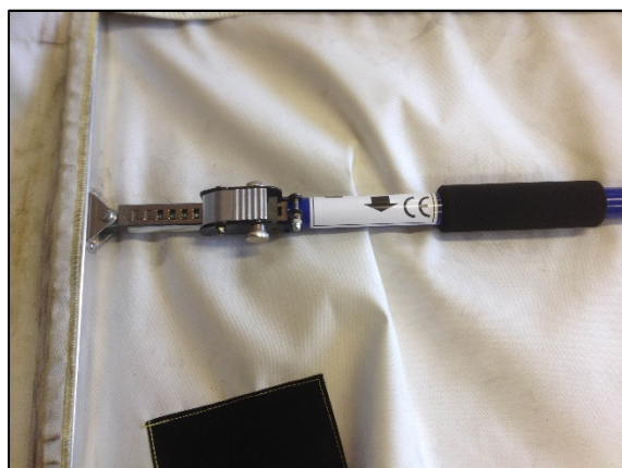
Figura 4 Primo piano del meccanismo di posizionamento dello smoke stopper. Premendo la clip l'asta può essere regolata. Successivamente ruotando la barra nella direzione della freccia, si aggiunge la tensione per tenere il dispositivo in posizione ( Photo: Karel Lambert )
