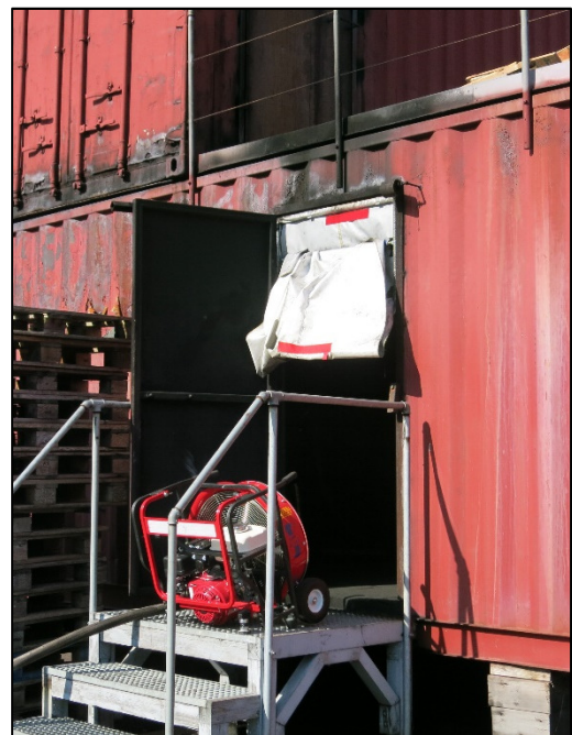
Figura 6 Lo smoke stopper chiude la metà superiore della porta. Il riflusso causato dal ventilatore viene limitato. Il ventilatore può essere quindi posizionato più vicino alla porta. (Picture: Michael Reick)
